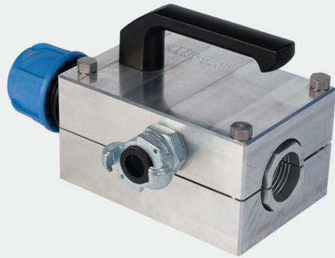
Y-Block zur Installation des zweiten und dritten Kabels. Maximal 16 mm und 12 mm. Kann mit Schellen Ø 25-32-40 oder 50 mm zum vorhandenen Rohr geliefert werden. Kann mit Rohradapter Ø 25-32-40 oder 50 mm geliefert werden. Verbindung zwischen Y-Block und Maschine.
